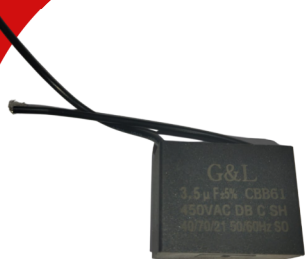
CAPACITOR 3,5UF POR 450V
