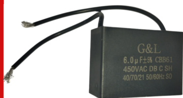
CAPACITOR 6,0UF POR 450V
